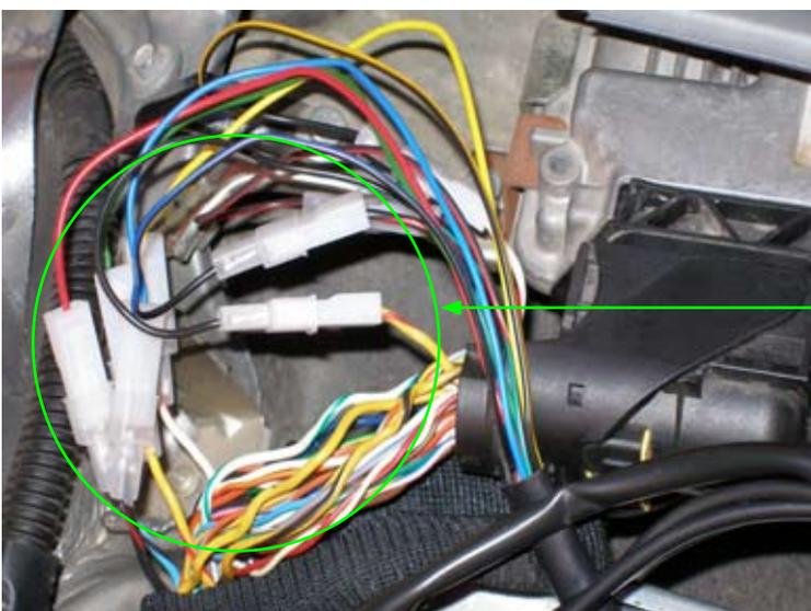
**Per l'interruzione dell'iniezione BENZINA, collegare i cavi provenienti dalla centralina GAS come schematizzato a pag.5**
